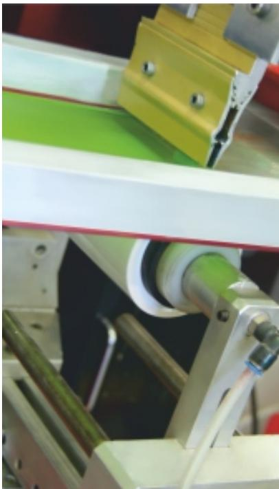
**Direktdruck** Siebdruck direkt auf der Oberfläche des Bechers
